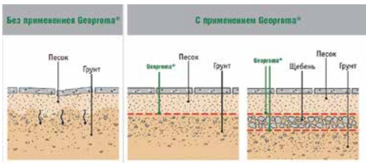
Укладка геотекстиля Георгота® в основание дорожек повышает несущую способность конструкции, ограничивает ее осадку. Предотвращает вдавливание щебня в грунт, вымывание песка в щебеночный слой.
