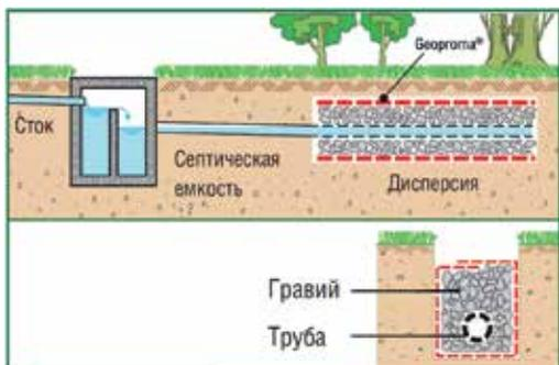
Георгота®, обладая высокой прочностью и хорошей водопроницаемостью при сохранении высокой фильтрующей способности, позволяет создавать простые и эффективные системы мягкого дренажа для отвода грунтовых или сточных вод.
