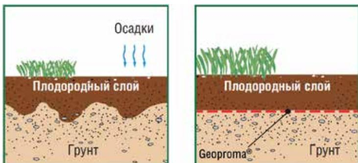
Для озеленения грунтов, непригодных для роста культивируемых растений, требуется нанесение плодородного слоя грунта, который незащищен от вымывания и смешивания с тощими грунтами. Георгота®, уложенный под плодородную почву, предотвращает ее вымывание и смешивание, но не препятствует свободному току воды в слоях грунта.
