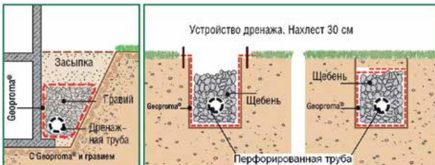
Для защиты фундаментных стен от грунтовых вод создаются эффективные и простые в укладке дренажи с применением Георгота®, который предотвращает проникновение мелких фракций грунта в дренажный слой и заиливание дренажных труб.
